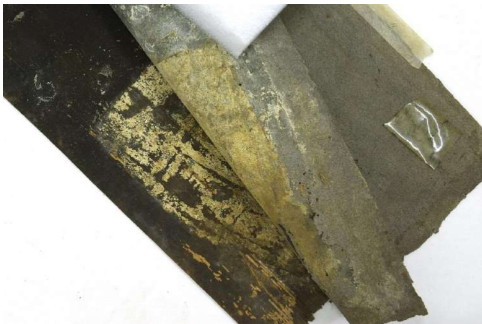
Příklad vzájemné adheze jednotlivých vrstev zadního krytí. Šedá lepenka se rozpadá na drobná vlákna.
